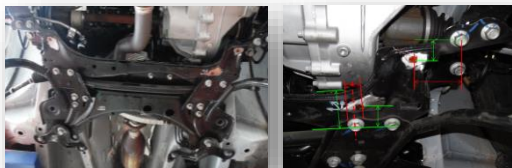
图1 - 副车架试验方案设计及传感器安装
